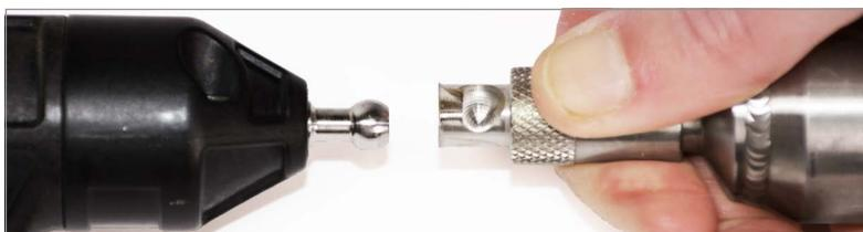
**FIGURA 4:** Retraiga la cubierta del resorte
