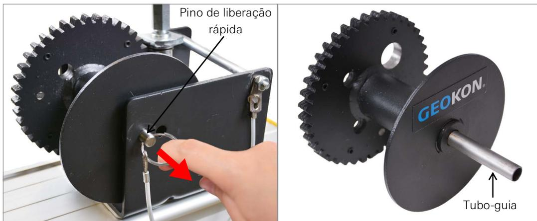
**FIGURA 43:** Remova a bobina vazia e o tubo-guia
