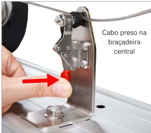
**FIGURA 51:** Cabo de apoio preso na braçadeira central
