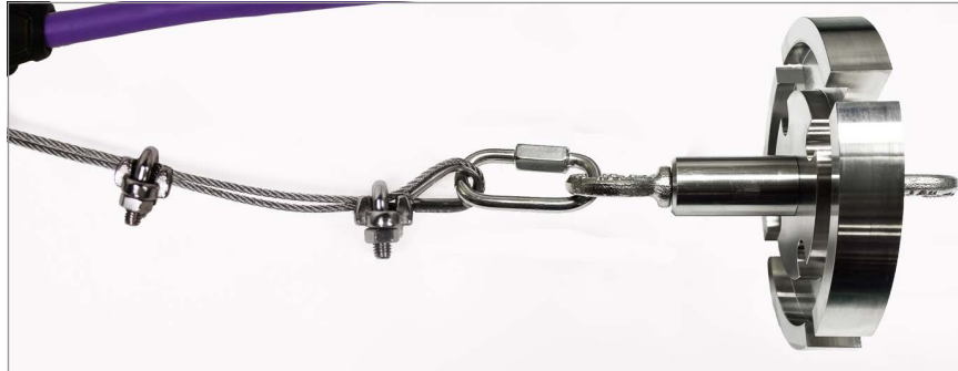
ABBILDUNG 56: Endgültig angepasste Kabelmontage
